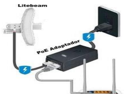
Figura 40. Conexión y configuración de la 2da. antena Ubiquiti.
