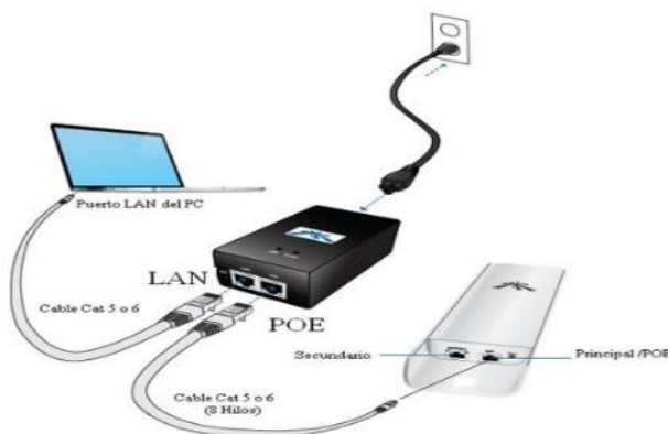
Figura 35. Conexión y configuración de la 1er. antena Ubiquiti.
